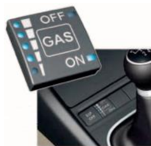
Figura 21. Conmutador de GLP. Fuente: Volkswagen.
