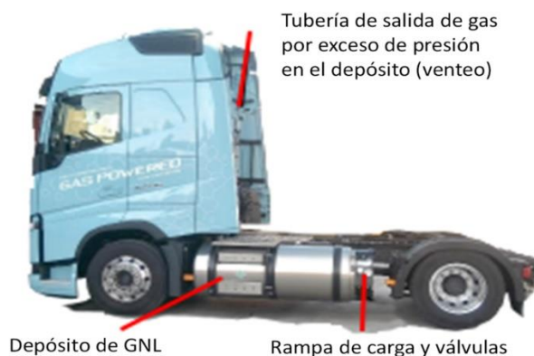
Figura 34. Componentes de un vehículo de GNL. Fuente: Volvo.
