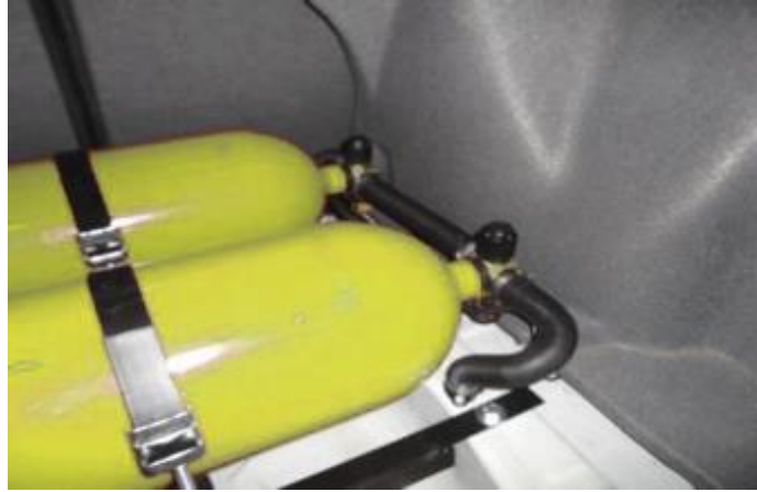
Figura 30. Canalizaciones de GNC en un turismo. Fuente: Ferrosite
