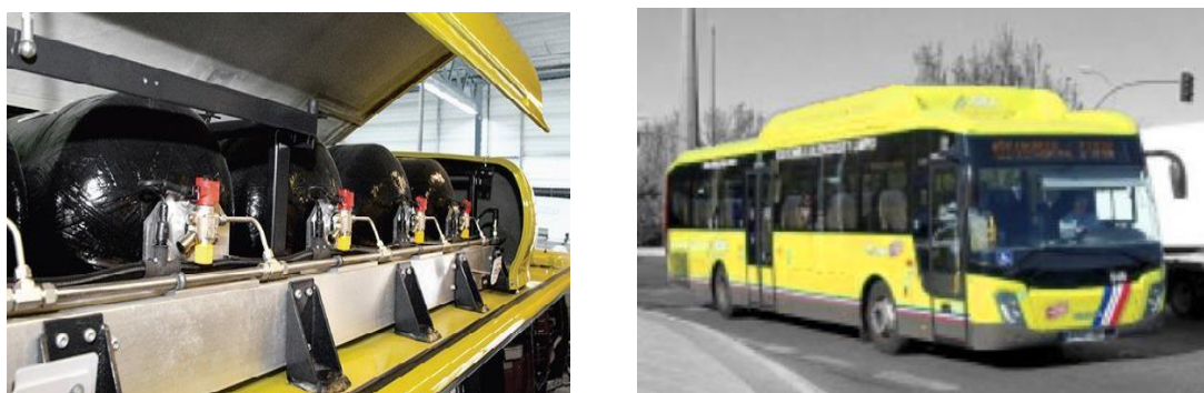
Figura 27. Depósitos GNC en un autobús. Fuente: Ferrosite
