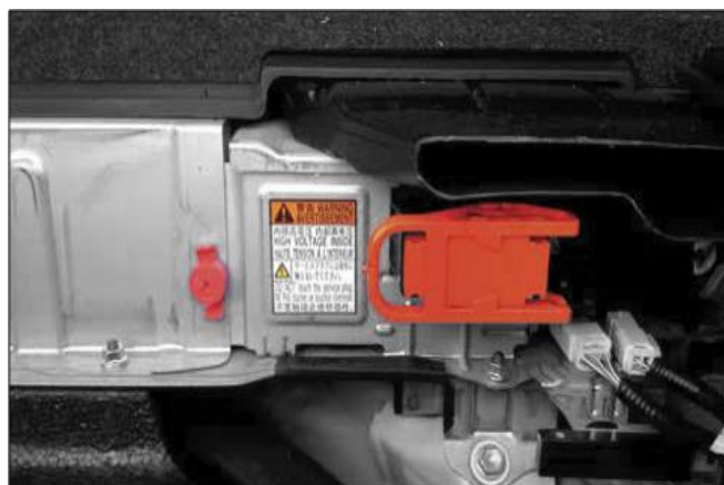
Figura 10. Plug service. Fuente: Toyota.
