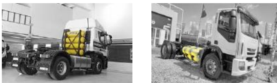
Figura 28. Depósitos GNC en un camión. Fuente: Ferrosite
