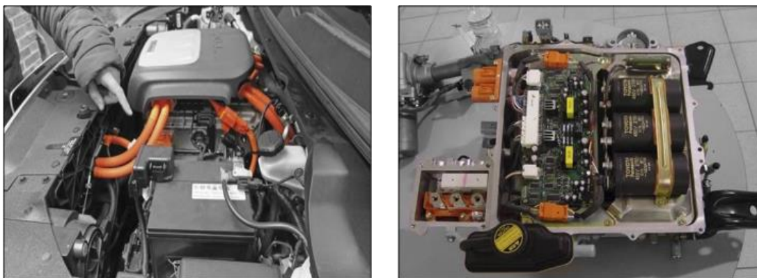
Figuras 7. Inversor/Convertidor. Fuente: Toyota.
